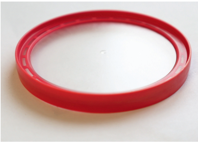
2K-Membrane: Die Neuentwicklung einer Zweikomponentenlösung aus Silikon und Thermoplast im mechanischen Verbund war der Schlüssel zur prozesssicheren Herstellung © Rico
